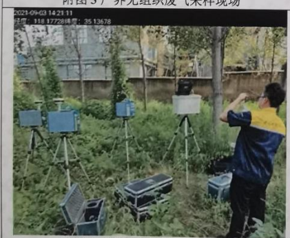
附图5 厂界无组织废气采样现场
