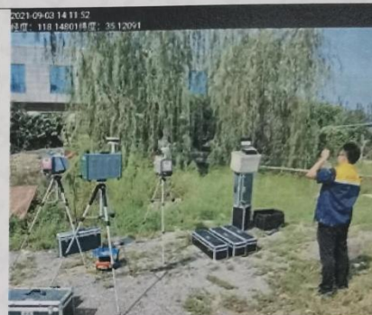
附图2 厂界无组织废气采样现场
