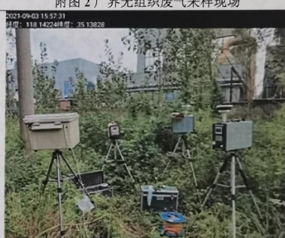
附图4 厂界无组织废气采样现场
